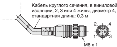
Расположение выводов разъема приемника
